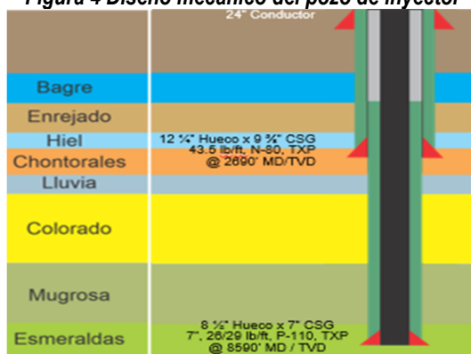
Figura 4 Diseño mecánico del pozo de inyector
